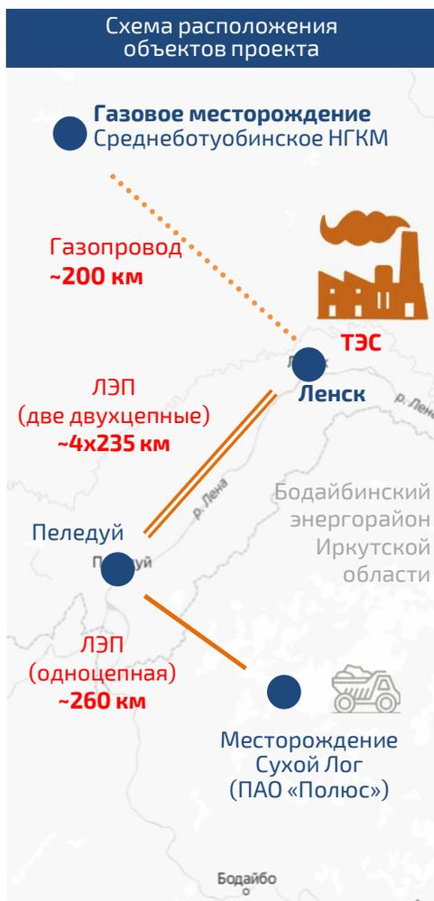
В соответствии с решением Правительства РФ определена необходимость строительства нового генерирующего объекта для покрытия прогнозируемого дефицита мощности в Бодайбинском энергорайоне
